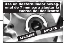
Ajuste el deslizante insertando un destornillador hexagonal de 7 mm para girar la tuerca deslizante.
